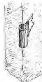
gond scellé dans la maçonnerie
