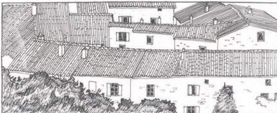
Les toits en Revermont: des toitures à deux pans, de faible pente, des volumes simples résultant de l'alignement de maisons mitoyennes le long des crêtes et dans les vallées.
