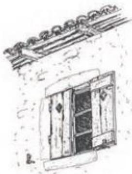
Élément fonctionnel (occultation de la lumière, protection des menuiseries, protection contre les effractions, protection thermique), le volet a aussi souvent été utilisé, dans un but esthétique de décoration et de composition d'une façade. Les volets étaient pris en compte dans la composition et l'ornementation des façades au même titre qu'une chaîne d'angle, qu'une moulure ou une frise.
